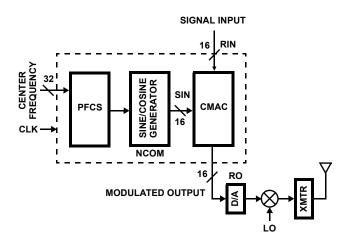
FIGURE 4. AMPLITUDE MODULATION
