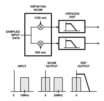
FIGURE 6. CHANNELIZED RECEIVER CHIP SET
