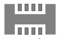
(d) Copper Area =  $50 \text{mm}^2$ ,  $\theta_{\text{JA}} = 51^{\circ}\text{C/W}$
